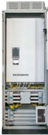
Typ A 600 mm Umrichterschaltschrank: Emotron FDU/VFX 2.0 160-355 kW, 400/690 V, IP23/IP54
