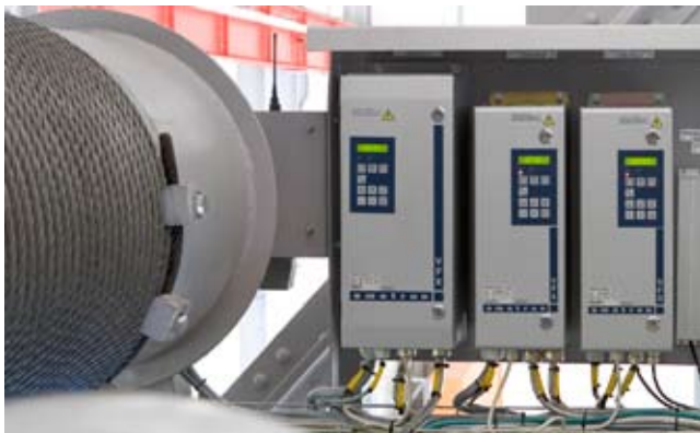
Die nach IP54 ausgeführte Kapselung ermöglicht die Installation von Frequenzumrichtern auf Kranbrücken und an der Laufkatze. Dies reduziert die Installationskosten.
